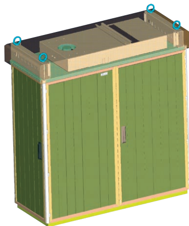
Schrank mit einem Wärmetauscher im Dach
